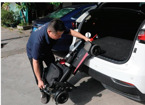
1. Heben Sie den Griff an und legen Sie die Vorderseite des Fahrzeugs in den Kofferraum.
