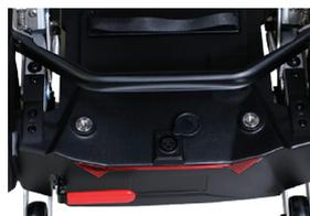
Stecken Sie dann den Netzstecker in die hintere Ladestation des Fahrzeugs.
