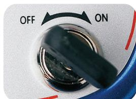
Schalten Sie zuerst den Strom am Schlüsselschalter aus.
